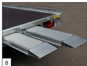
**De série :** avec logement des rampes intégrées sous le plancher.
