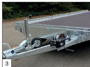
**De série :** avec une treuil montée avec support réglable sur le devant.
