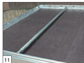
**Option :** blocage de roue modèle Combi Protect Rail réglable.
