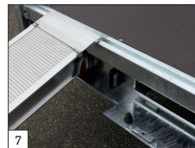
**De série :** avec profilé en U à l'arrière-côté pour mettre les rampes dedans.
