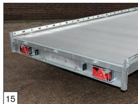
**Option :** plancher en profilés aluminium et protection de feux montées à l'arrière-côté.
