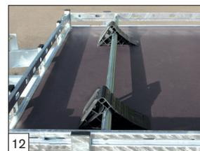
**Option :** blocage de roue modèle Combi Protect Rail réglable avec 2 blocages noirs.
