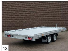
**En série :** une rambarde Combi Protect Rail (80 mm) fixe sur les côtés et le devant.
