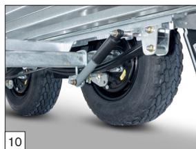
**Option :** les modèles Indigo HF en 3 500kg PTAC sont livrables avec des essieux paraboliques avec amortisseurs. Les pneus 195/50 R13 sont avec des jantes noires.
